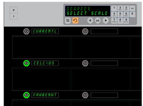
「dEGrEES」(温度数) に近接するタイマーを押すことで、上で示される表示が現れます。目的の温度範囲の横のタイマー ボタンを押します。
