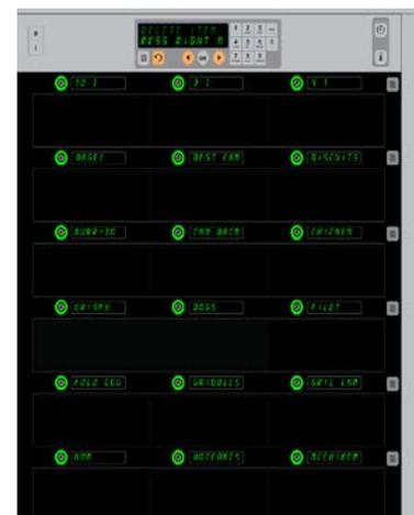
メニュー アイテムが表示されているキャビネット。削除されるべきアイテムがタイマーキーで選択されています。この削除はコントローラ上の [OK] キーで確認されます。
